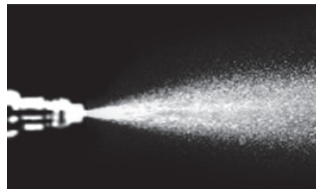
Forme du jet de l'injecteur après le traitement au P.i.
